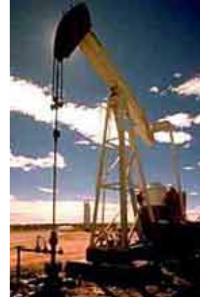
Kad pritisak padne potrebno je gas pumpati iz zemlje. Za to služi pumpa nazvana "konjska glava".
