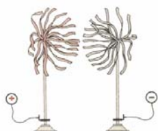
Slika 3.4 – 2 Oblik električnih linija sila kod raznoimenih naelektrisanja
