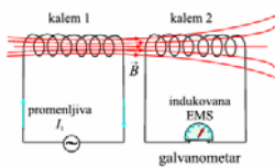
Slika 11.24: Promene u prvom kalemu indukuju elektromotornu silu u drugom.
