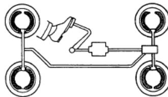
Slika 6.8: Hidraulični kočioni sistem kod automobila.
