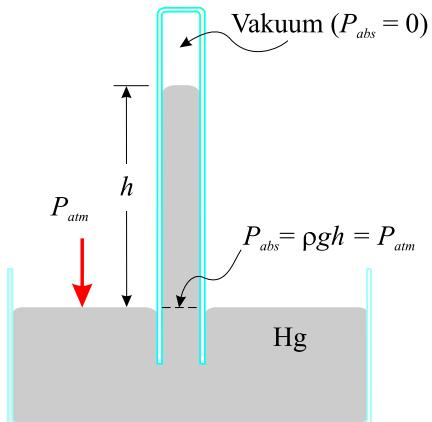
Slika 6.14: Barometar sa živom za merenje atmosferskog pritiska.
