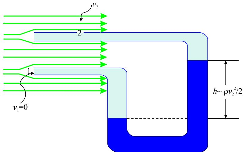
Slika 6.35: Merenje brzine fluida zasnovano na Bernulijevom principu.
