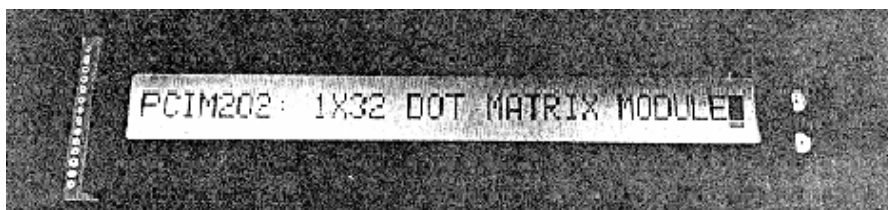
Sl. 6.52. Modul tačkasto-matričnog alfanumeričkog LCD displeja.
